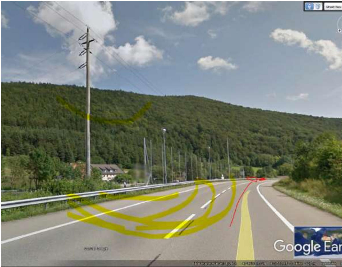
Starkes E-Feld aufgrund der winkligen Wegführung der Leitung.
