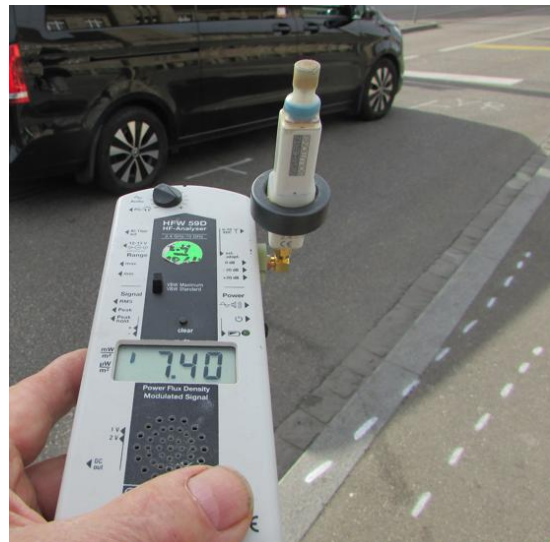
Gefahrenre Unfallstrecke Einstrahllinie mit Reflexion an Ausgangslage Messung an der Abfahrtstelle 7 mW/m 2 und Höhe Trottoirauffahrt
