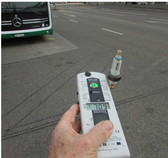
Gefahrenre Unfallstrecke Einstrahllinie mit Reflexion an Ausgangslage Messung an der Abfahrtstelle 7 mW/m 2 und Höhe Trottoirauffahrt
