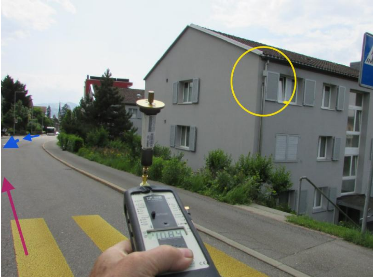
Am Ort des Einschlagvorgang werden für einen Sender „sehr klein+ extreme 10.84 mW/m 2 gemessen
