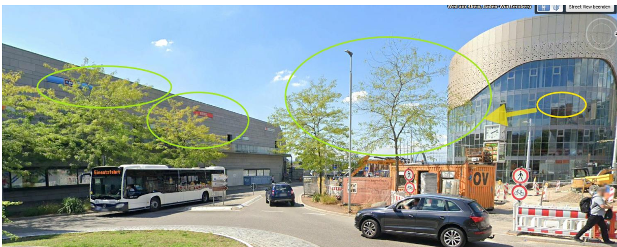
Die Reflexionsfläche wandert am gerundeten Gebäude bei der Anfahrt auf die Haltestelle kontinuierlich, entsprechend sind auf dieser Höhe klare Kronenschäden erkennbar:
