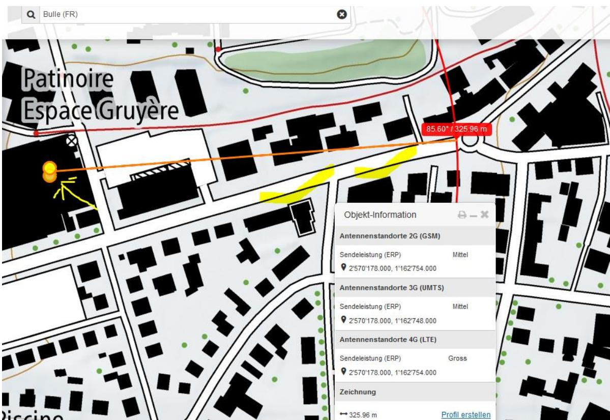
Doppelstandort, wie im oberen Bild gezeigt, korrekt: 20m südlicher, überstrahlt die niedrigen Gebäude alle.
