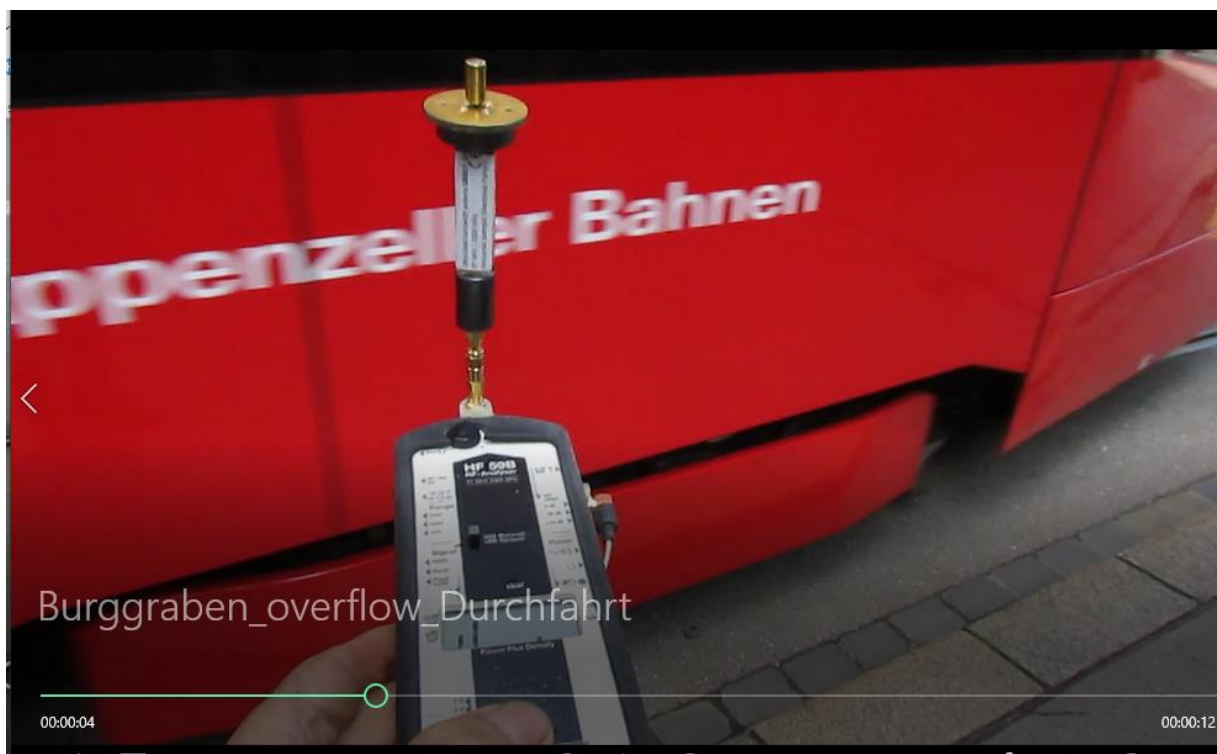
Die nach Passage des Bordeigenen Senders wieder abfällt. Der Fahrer ist noch stärker exponiert, weil sein Kopf in Fahrposition noch einmal 40-50 cm höher und in der Trottoirmitte stärker exponiert ist als bei dieser Messung.
