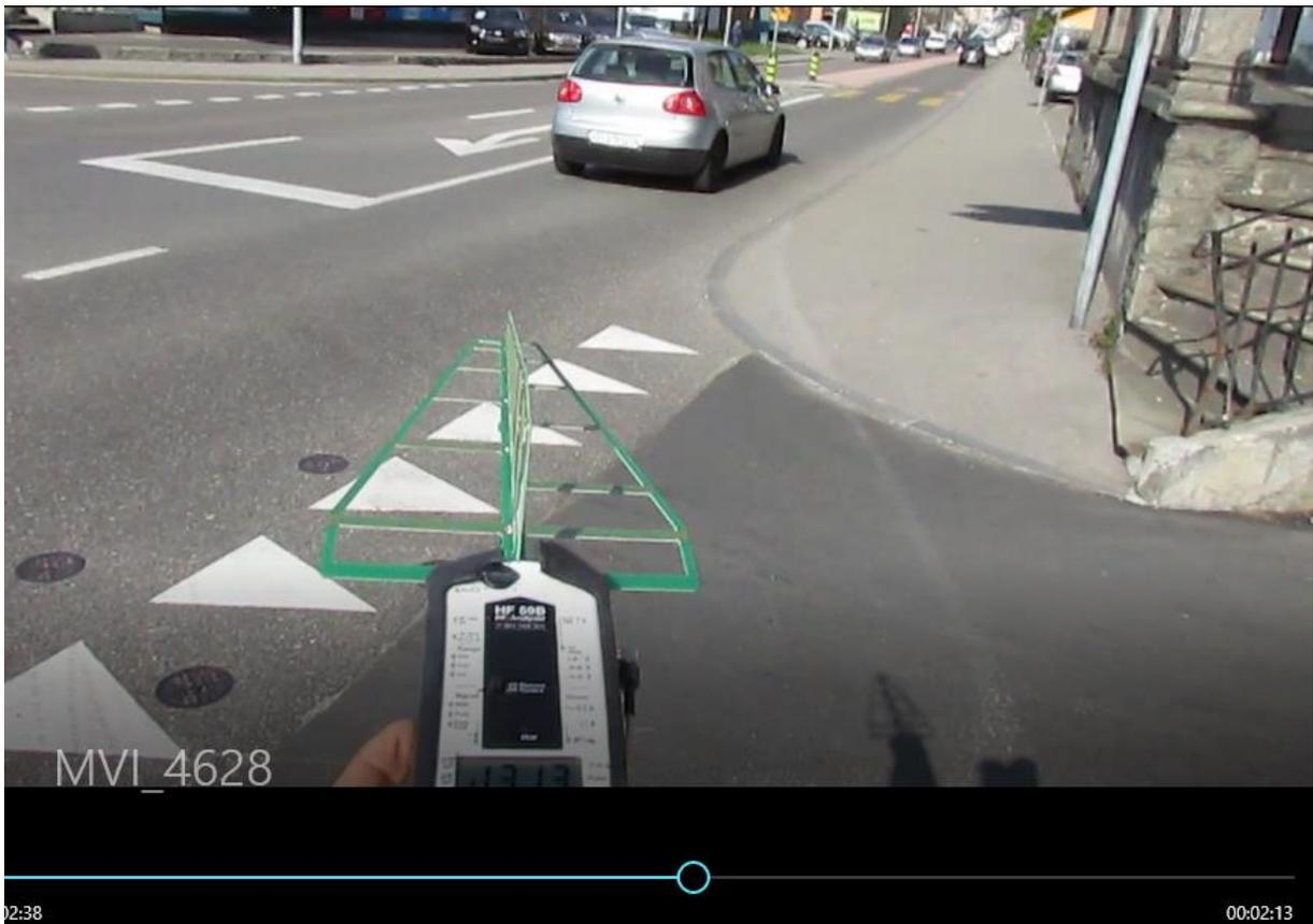
Maximaler Wert 131  $\mu\text{W}$  aus der Richtung der Stabantennen auf dem Garagengebäude.
