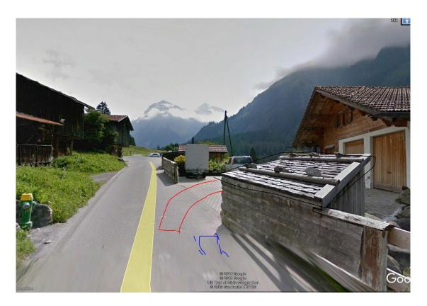
Der tiefer liegende Sender wird durch das Nachbargebäude abgeschirmt, ein Funkeinfluss ist unwahrscheinlich. Die an die Strasse grenzende Kleinbaute erschwert die Sicht.
