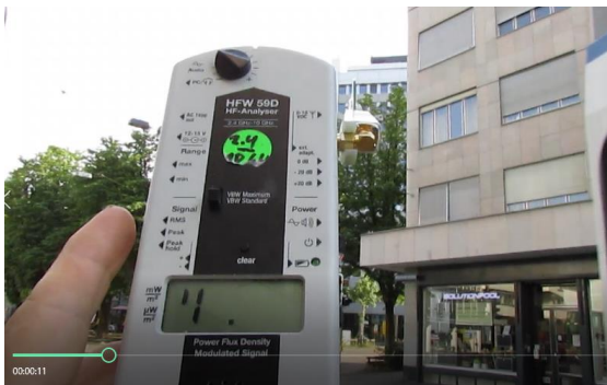
Das Tram verlässt den direkten Strahlungsraum, Sendeleistung bleibt bestehen: über 20 W/m 2
