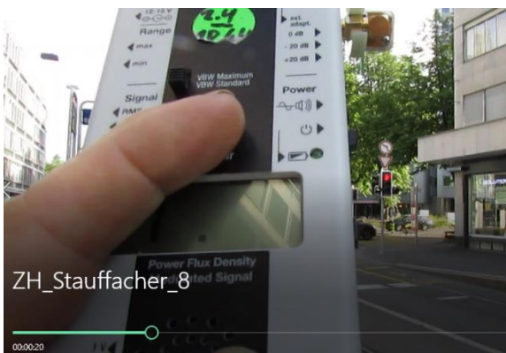
Das Tram verlässt den direkten Strahlungsraum, Sendeleistung bleibt bestehen: über 20 W/m 2
