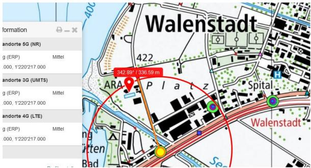
Sender von der Seestrasse strahlt ein. Ab dem Ort hoher Reflexion an Stahltanks der ARA und Mulden noch 170m Fahrstrecke bis zur Endlage
