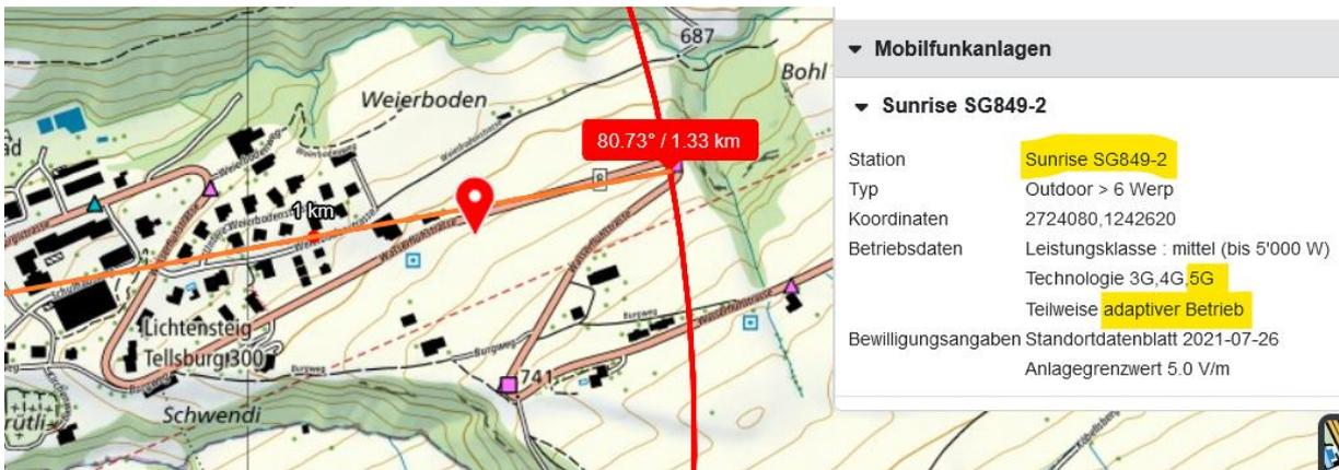
Die Leistungsdaten (aus BAKOM-Daten) von 5G am 5. November 2023 an diesem Standort sind 3750 MHz, 357 W erp, Azimut 100°
