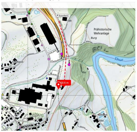
Die angezeigten 500m weisen auf die <u>Tunnelmitte</u> hin. Hier müsste aus funktechnischen Gründen ein Sender platziert sein, der Sender aussen erschliesst den Tunnel nicht, der Portal-Sender ist hier:
