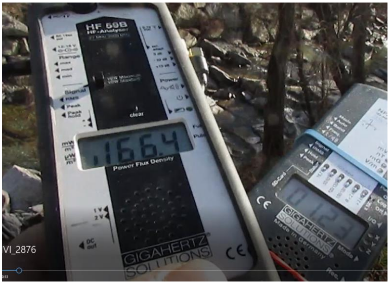
Messung mit omnidirektionaler Antenne und Logger (Datei 267 / 21.01.18 11:20)
