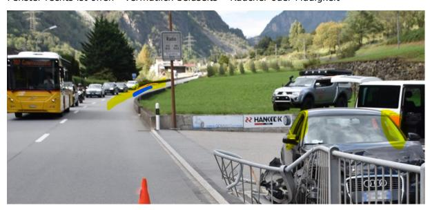
Die Strahlung vom erhöhten Senderstandort reflektiert auch an den Flanken des Gegenverkehrs auf den bergabfahrenden Lenker
